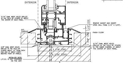
NOTE: MAKE SURE THAT ANY FASTENER HOLES AND EACH END OF THE SILL ARE SEALED PROPERLY. FROM THE FRONT FACE OF THE SILL DRILL HOLES ALL THE WAY TO THE BACK AS SHOWN AT A SLIGHT ANGLE UPWARD TO NOT PUNCTURE THE SILL BOTTOM EXTRUSION.
